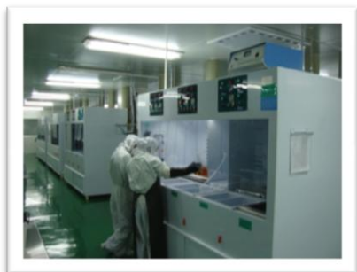
Формирование Ni/Au контактных площадок
