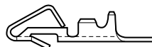
Гнездовой контакт с однократным касанием, с низким контактным нажатием (Номинальный ток 6,5 А)
