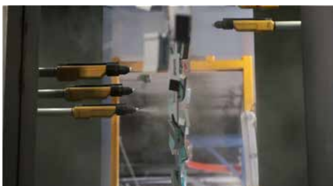
Нанесение порошковых покрытий
