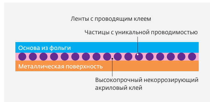
Рис.2. Поперечное сечение экранирующей ленты с проводящим клеем
