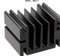
P-6837 FISCHER 46x33x37,5 мм Площадь поверхности 200 кв.см Вес: 80 г
