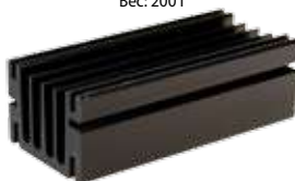
P-68100 FISCHER 46x33x100 мм Площадь поверхности 530 кв.см Вес: 200 г
