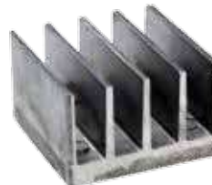
P-242 42x42x26 мм Площадь поверхности 81 кв.см Вес 50 г
